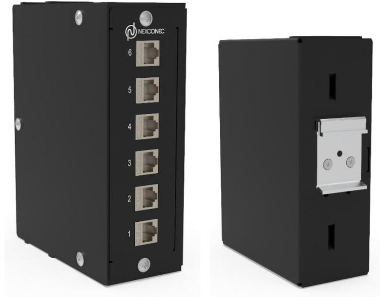
Caja de parches compacta para riel DIN con 6 conectores Ethernet RJ45 que admiten cableado CAT 5e/6/6A blindado o no blindado. El tamaño compacto permite requisitos mínimos de espacio dentro de la cabina de control. El dispositivo incluye aberturas en la parte superior e inferior del panel de parches para acomodar un gran volumen de cables Ethernet en el campo.
